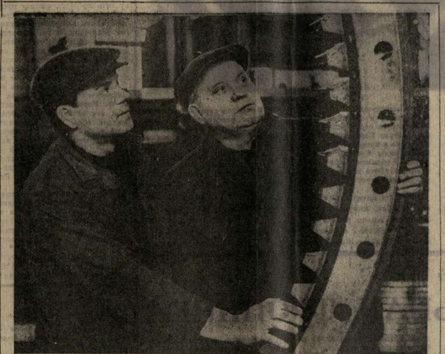
Опорно-поворотное устройство для багетных крапов — одно из серийных изделий Воронежского механического завода № 5. Наиболее трудоемкой и, пожалуй, самой ответственной операцией при их изготовлении является нарезка зубьев. Фрезеровщик механического цеха, кандидат в члены КПСС Михаил Дмитриевич Золотарев решил освоить новую для себя профес...
