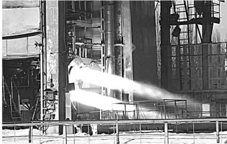
Огневое испытание ракетного двигателя РД-0124 в КБХА.
