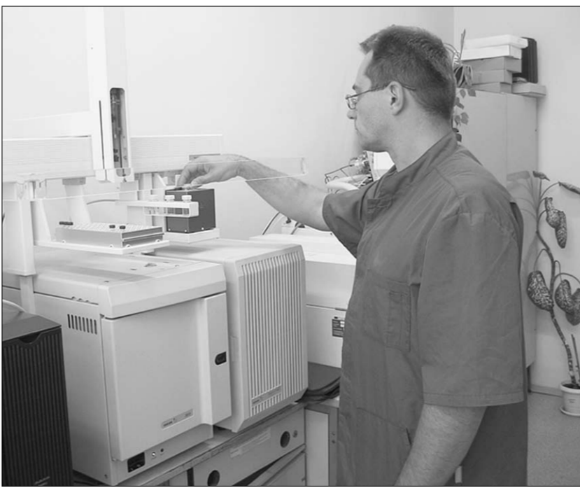
Химик-эксперт Алексей Кустов на хроматомакс-спектрометре проводит исследование воды, расфасованной в емкости.
