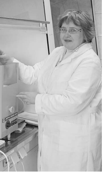
Инженер по качеству аттестованной испытательной лаборатории Наталья Яковлева проводит анализ фракционного состава дизтоплива.
