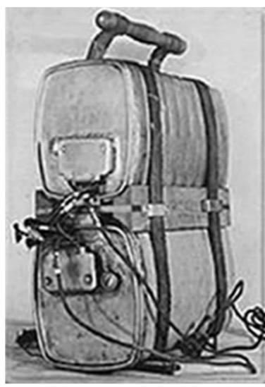
Прибор ФДТ для управления радиофугасами тактического действия.
