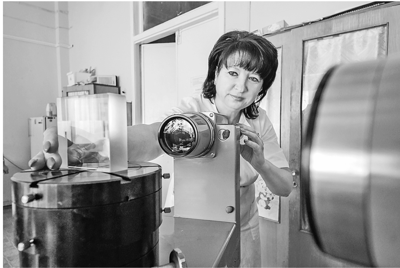
Алла Ляпина, ведущий инженер за работой на гониометре для поверки угловых мер.
