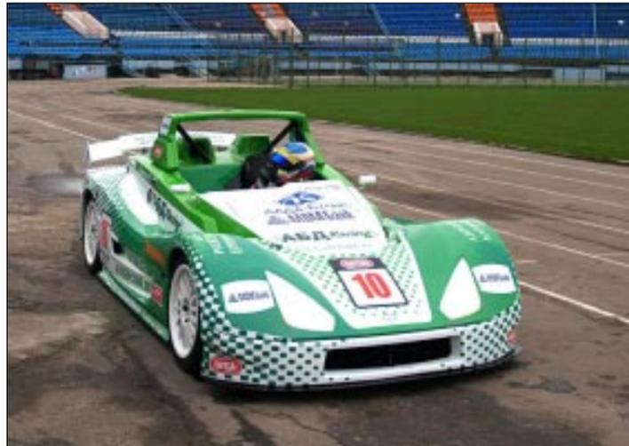
Технические характеристики соответствуют гоночным болидам. Двигатель объемом 1.6 л., 200 лошадиных сил, развивает максимальную скорость 250 км/ч, до 100 км/ч разгоняется за 6 секунд.
